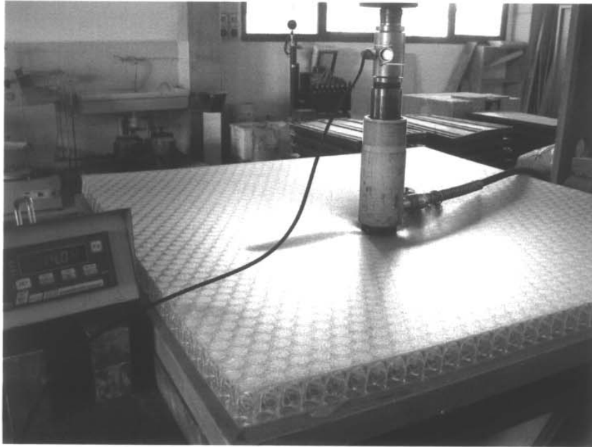
Sample 2: fotografia del campione al carico massimo raggiunto.
